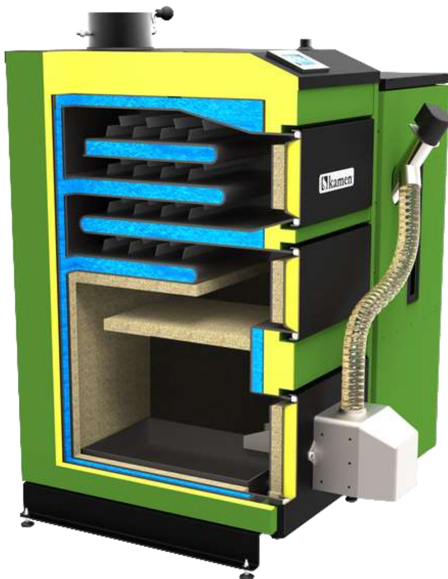
Rys 1. Przekrój kotła Kamen PELLET KOMPAKT
